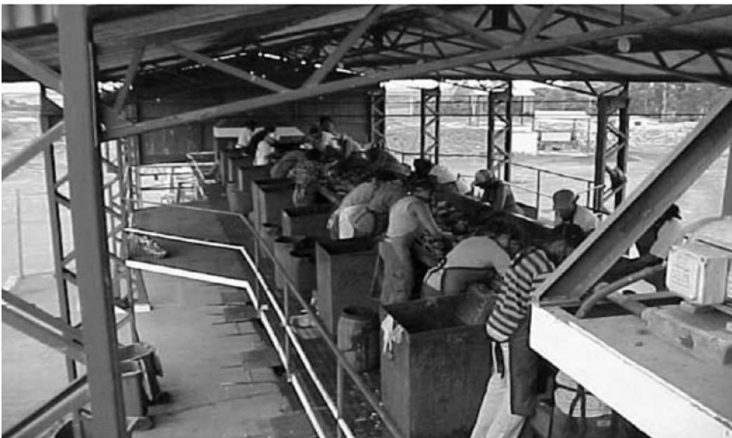
**Figura 3 Esteira de separação de usina de compostagem simplificada (Castilhos Jr (coordenador), 2006)**
